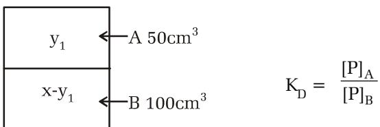
$$5 = \frac{(y_1 / 50 \times 10^{-3} \text{ dm}^3)}{(x - y_1) / 100 \times 10^{-3} \text{ dm}^3}$$
